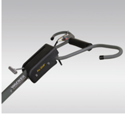
Pro-Shift® sistemine sahip, yüksekliği ayarlanabilir tutma kolu perdelama bıçağının ayar açısının kademesiz bir şekilde değiştirilmesi ve bireysel yükseklik ayarı için kullanılabilir
